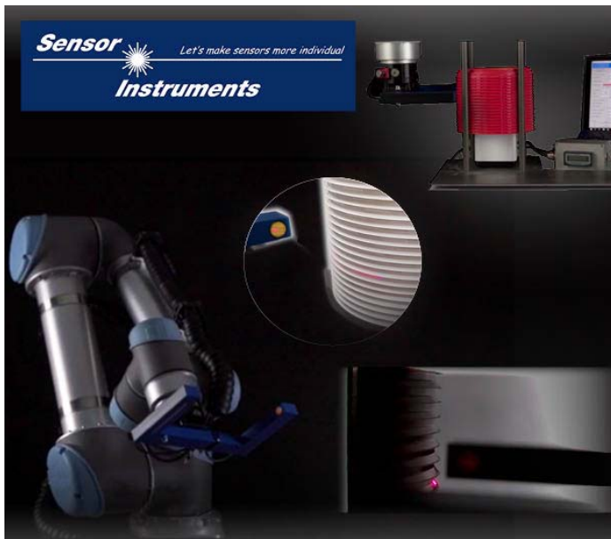
Sensor de luz transmitida por láser para el conteo rápido y preciso de tapas de plástico apiladas
